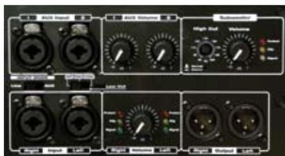
**Модель QM-650 AS** — компактный активный сабвуфер. Оснащен встроенным кроссовером с возможностью изменения частоты раздела. QM-650 AS имеет стереовход на универсальных разъёмах (XLR и JACK), балансный выход (XLR) с буферным усилителем и фильтром высоких частот с тремя режимами работы (full range, 80 Гц и 125 Гц).
